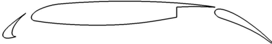
Fig. 2 30P/30N airfoil geometry (Klausmeyer, 1994)
